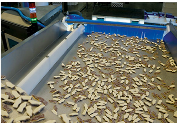
Picture 2: Des éjecteurs ultramodernes éliminent les bonbons gélifiés ou les confiseries non conformes en quelques millisecondes (Photo: TOMRA Food)
