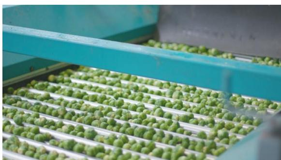
Tryvan utilise des machines de tri optique TOMRA. Ce trieur a une capacité de 10 tonnes/h.
