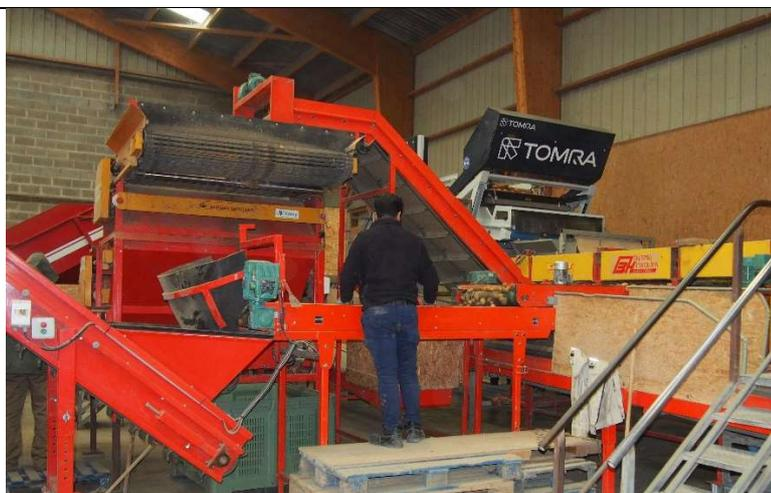
La TOMRA 3A analyse les tubercules durant la chute, et éjecte au vol les produits présentant des défauts et des corps étrangers (pierres, mottes de terre, etc.).
