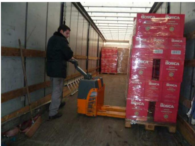
« Ce transpalette électrique a un encombrement identique à celui d'un transpalette manuel. Les utilisateurs constatent qu'il leur permet de gagner en facilité d'utilisation, que ce soit pour déplacer une palette ou encore la manœuvrer en réserve comme en surface de vente », explique Serge PEIXOTO, directeur commercial de OMG France.
