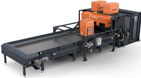
A large industrial sorting machine with a long conveyor belt and several orange TOMRA sorting units mounted on top. The machine is black and orange. | <p>La nouvelle technologie LOD (détection d'objet par Laser) offre aux centres de tri une solution robuste, sobre en énergie, pour répondre aux exigences de pureté les plus strictes de leurs clients.</p> |
