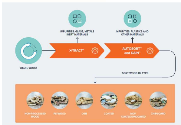
Processus de triage du bois avec la technologie TOMRA
